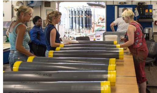
Die „Beute“ des Schwereloteinsatzes in handliche Meterstücke zerschnitten auf dem Arbeitstisch im Geo-Labor. Foto: C. Rohleder
