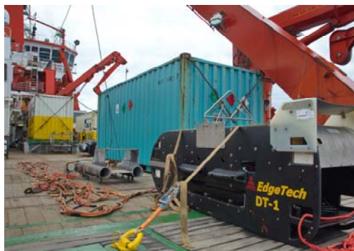
Abb. 3: Das tief-geschleppte Sidescan -Sonar (DTS) kurz vor dem Einsatz. Das eigentliche Gerät hängt hinter einem 750 kg schweren Vorlaufgewicht.
