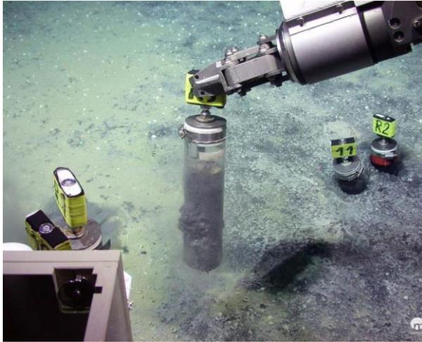
**Abbildung 3:** Push-Kern-Probenahme von MARUM ROV QUEST am Meeresboden.
