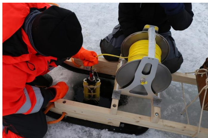
Abb. 1: Ein Team des IOW lässt eine Mini-CTD durch ein Eisbohrloch zu Wasser (Foto B. Hentzsch)
