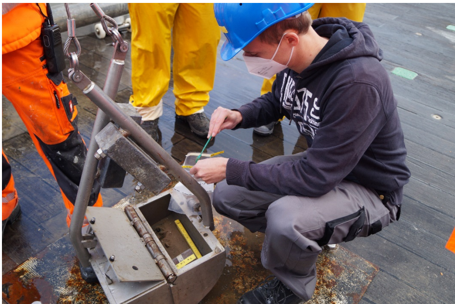
Abbildung 2: Beprobung der Oberflächensedimente an einem Backengreifer.
