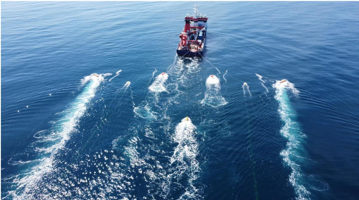
*Abbildung 1: Luftaufnahme von der MARIA S. MERIAN mitsamt dem geschleppten 3D-Seismik Equipment. Außen sind die Scherbretter zu sehen. Weiter innen erkennt man die kleinen gelben Kopfbojen der Streamer-Messkabel. Man kann sogar die gelben Streamer-Messkabel unter Wasser erkennen. Die Streamer sind jeweils 1050 m lang. Weiter innen sieht man die Auftriebskörper der seismischen Luftpulser und ganz innen mittig eine Navigationsboje. (Foto B. Hahn)*
