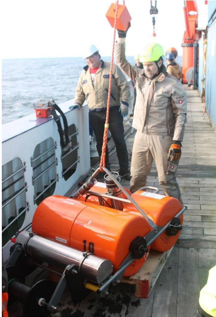
Abb. 2: Bergen eines Ozeanbodenseismometers (OBS). Die Geräte sind mit einer Spule und einem Seil (im Vordergrund des OBS zu sehen) mit dem Ankergewicht verbunden, das anschließend ebenfalls geborgen wird (Foto S. Steuer).
