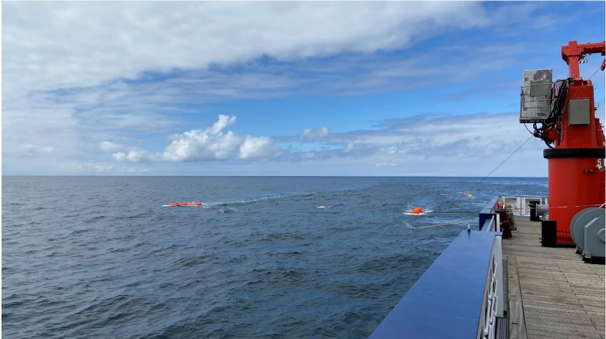
Abbildung 2: Blick auf die Messgeräte auf der Steuerbordseite. Außen ist das Scherbrett zu sehen, weiter innen die gelbe Kopfboje des Messkabels, die orangen Auftriebsbälle der Luftpulser und innen die gelbe Navigationsboje. Hier nicht zu sehen ist die gespiegelte Auslage der Messgeräte auf der Backbordseite.
