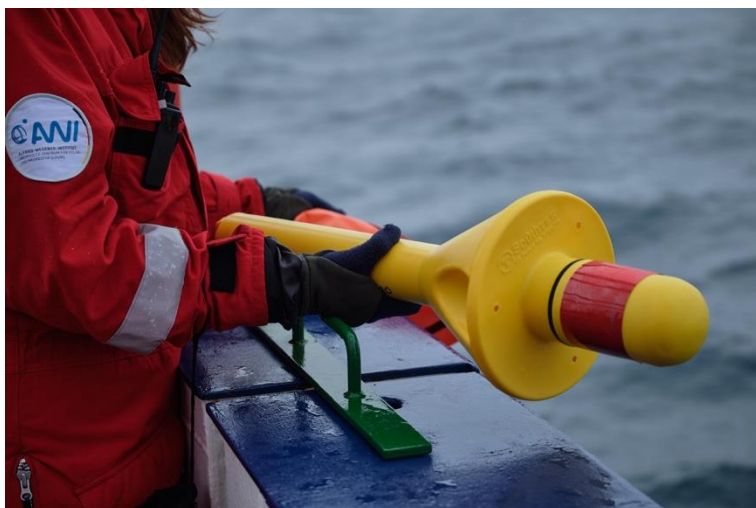
Foto 3: Ein Oberflächen-Drifter kurz vor dem Aussetzen. Nur der rechte Teil guckt aus dem Wasser und misst seine Position alle 10 Minuten und schickt uns die Position per Satellit. (Foto: T. Kalvelage)
