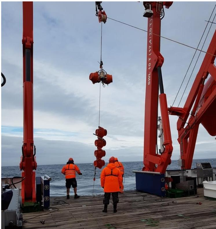
*Foto 1: Die Aufnahme einer Verankerung, die seit 2018 die Temperatur und die Strömung des Wassers gemessen hat, das in den Arktischen Ozean fließt. (Foto: W.-J. von Appen)*
