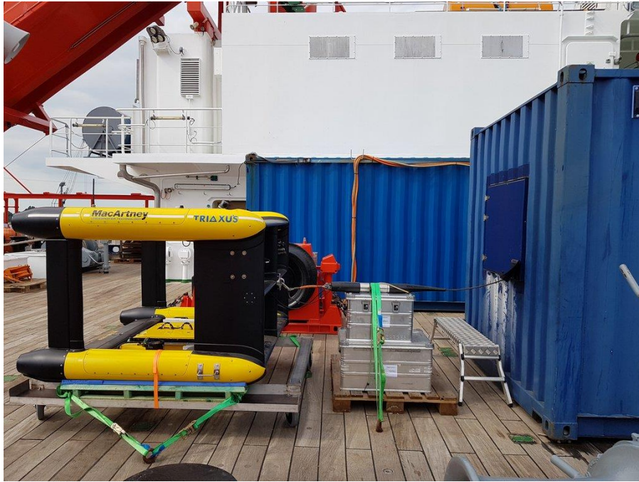
Foto 2: Das geschleppte Gerät Triaxus ist links in gelb zu sehen, in der Mitte ist das Schleppkabel, und rechts ist der Container in dem die spezielle Winde steht. Noch im Hafen konnte dies so an Deck aufgebaut und getestet werden.
