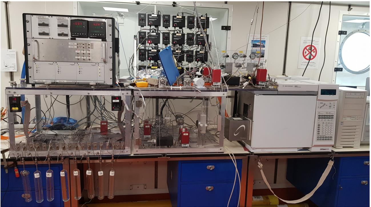
*Die Spurenstoff-Maschine zur Messung von Fluorchlorkohlenstoff (FCK) und Schwefelhexafluorid (SF6) im Ozean.*
