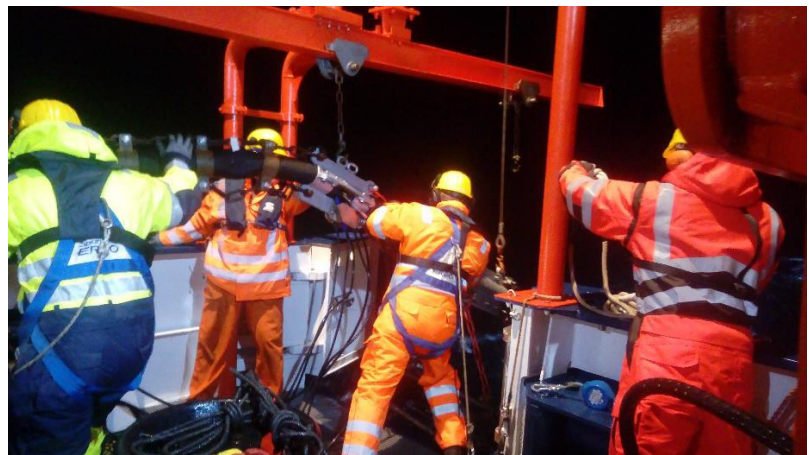
Unten: Die seismischen Luftpulser werden ausgebracht
