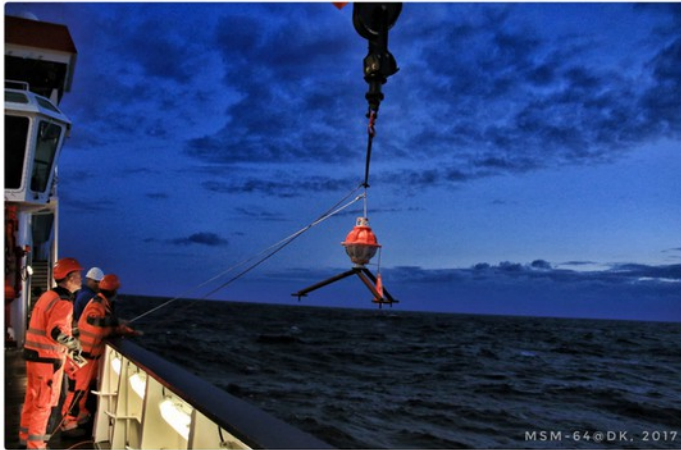
Abb. 1: Bisherige Reiseroute von MSM-64 (27.05.-1.06.2017, oben), Vorbereitung von Verankerungsgeräten (rechts) und Aussetzen eines Boden-Echolotes (PIES BP-32, unten).
