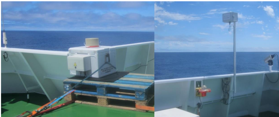
Abb.6 Die beiden installierten Wolkenkameranysteme des MPI-M auf der Maria S. Merian. Die ältere Kamera im Kühlbehälter (links) und die neuere kleinere (Vogelkasten-) Kamera (rechts).
