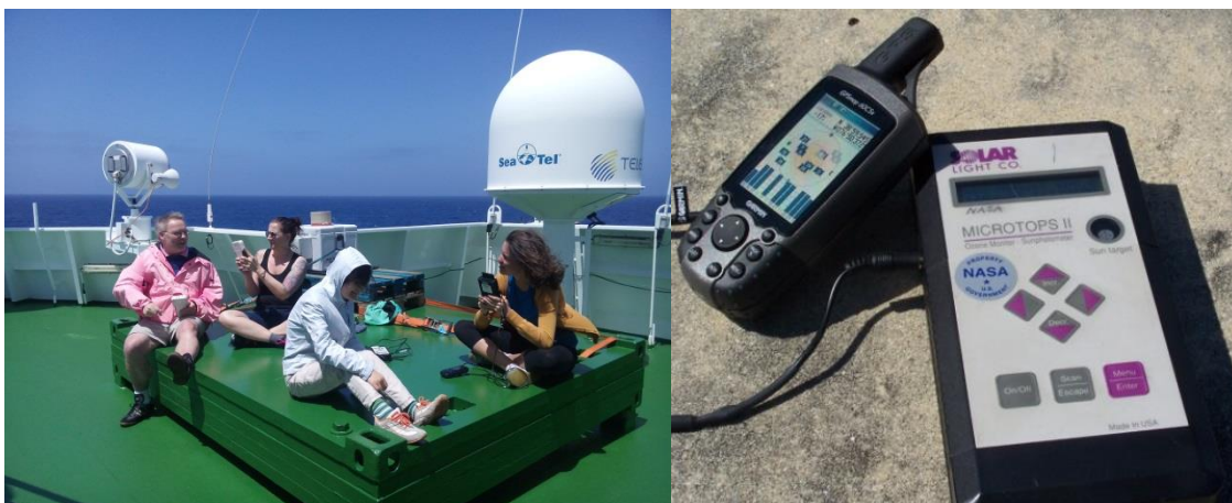
Abb 3 MICROTOS Messungen auf dem Peildeck (Foto: T. Mieslinger), Microtops/GPS von NASA's Marine Aerosol Network
