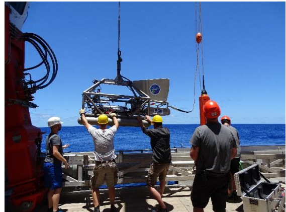
Einsatz des geschleppten Bathymetrie- und Sensorschlittens HOMESIDE im Lizenzcluster #3.
