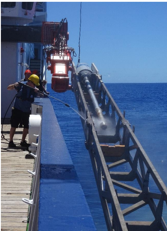
Bergung eines Schwerelotes ca. 50 km von der Rückenachse des CIR entfernt.
