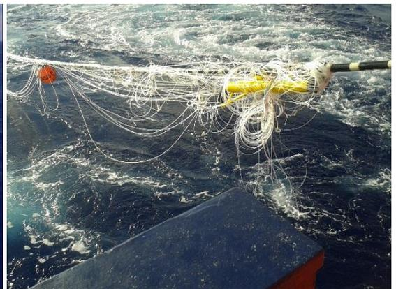
FS Maria S. Merian im Arbeitsgebiet mit den geschleppten 3D-seismischen Außenbordgeräten (von unten nach oben: Scherbrett, Steuerbord-Streamer, Steuerbord-Luftpulser, Backbord-Luftpulser, Backbord-Streamer) – (Luftbild: Emmerich Reize)
