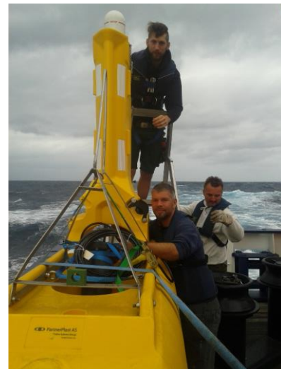
Installation von GPS und Funk auf einer Streamer-Endboje
