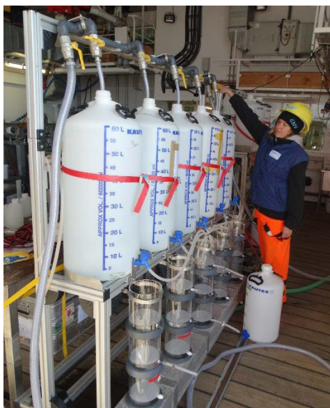
Großskalige Filtrationseinheit zur Trennung von Phytoplankton in verschiedene Größenfraktionen (Foto: P. Schmitt-Kopplin).
