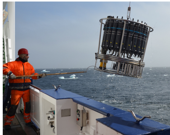
K. Peters beim bergen der CTD nach Vertikalprofilmessung (Foto: H. Schmidt)
