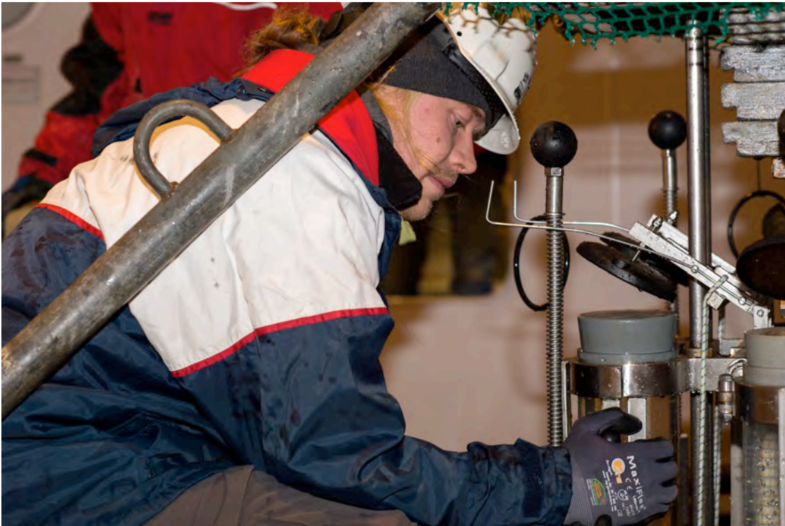
Marko Lipka entnimmt dem MULTICORER ein Stechrohr mit Bodenprobe.
