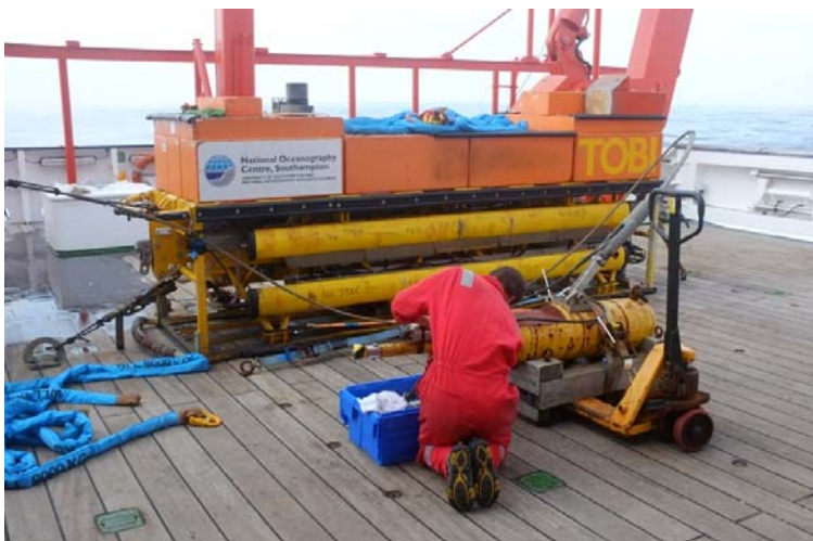
Vorbereitungen am TOBI-Sidescan Sonar an Bord der Merian. (Photo: P. Feldens)
