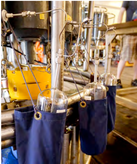
Spezielle Glasgefäße, mit denen Wasserproben luftdicht nach Kiel verschickt werden können zur späteren Analyse von gelösten Gasen.
