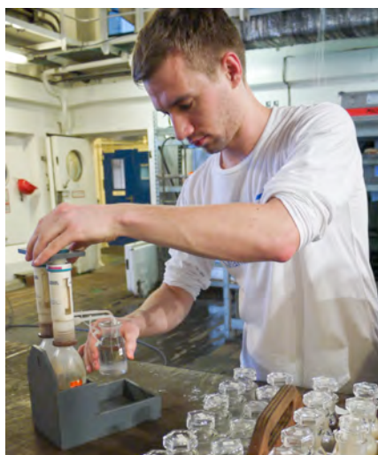
Wasserproben von der CTD werden für den Sauerstoffgehalt analysiert.
