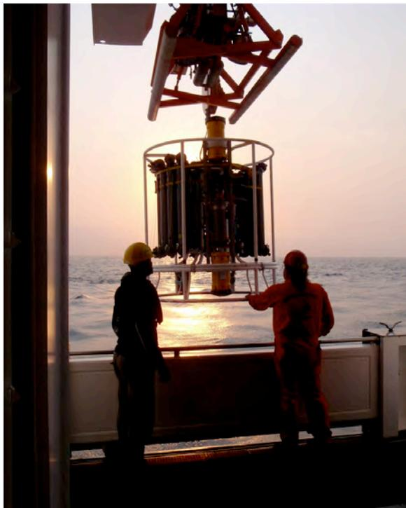
*Aussetzen der CTD Sonde an einem der wenigen ruhigen Tage.*
