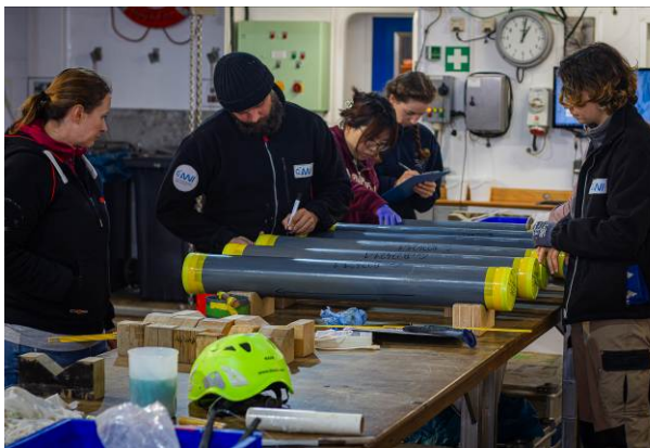
Abbildung 3: Ein Sedimentkern in 1-m Segmenten wird zur Beprobung in den Hangar des FS MARIA S. MERIAN gebracht und beschriftet. Foto: S. ten Hietbrink.
