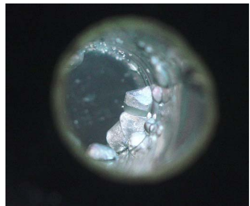
Abbildung 2: Beim Sammeln der Gasblasen bilden sich in diesen Wassertiefen Gashydrate. Copyright: MARUM Universität Bremen
