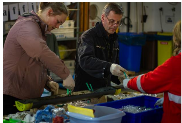
Abbildung 4: Nachdem die einzelnen Segmente geöffnet werden, können die Proben entnommen und die Sedimente beschrieben werden. Foto: S. ten Hietbrink.
