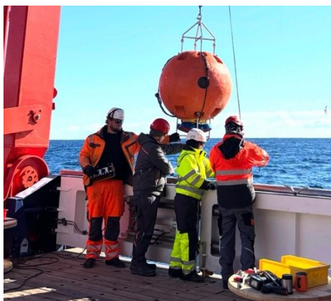
Abbildung 1: Ausbringen einer Verankerung nach der „Anchor-first“-Methode auf der MARIA S. MERIAN.
