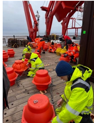
Abbildung 3: Überprüfung und Vorbereitung der Auftriebskörper (orange und gelb) an Deck (Foto: Eleanor Frajka-Williams)
