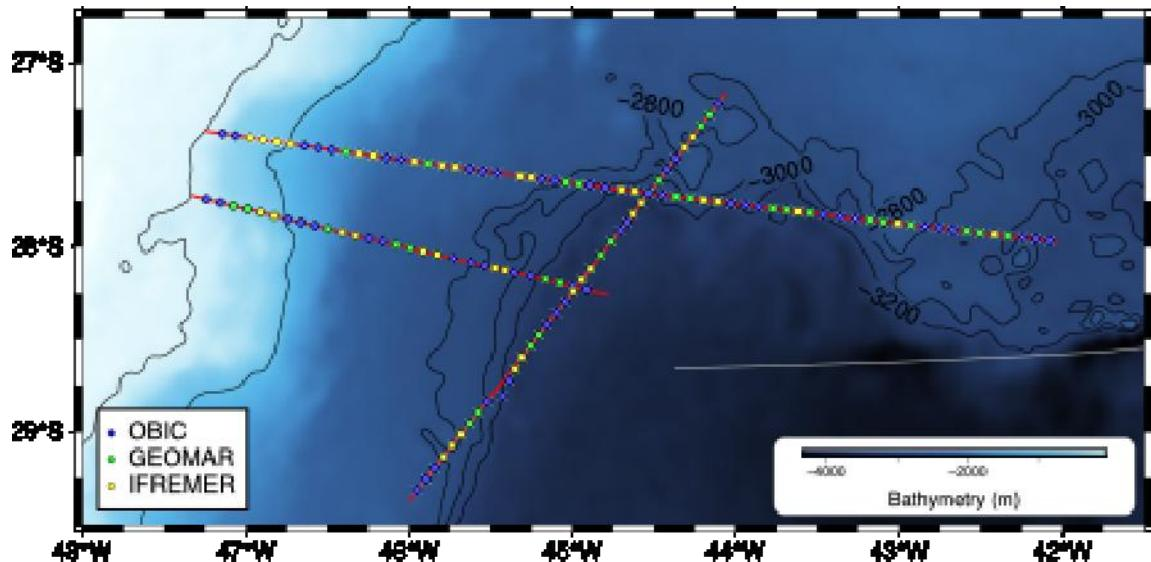
Abbildung 1: OBS-Stationen entlang der Linien 140, 220 und 150, farblich nach Institution gekennzeichnet. Alle OBS entlang aller Linien wurden geborgen (mit weißem Kreuz markiert). Nur OBS Nr. 3 am Anfang der Linie 140 ist verloren gegangen. Wir fahren nun fort, zusätzliche Swath-Bathymetrie entlang aller Linien zu messen, beginnend mit Linie 140.
