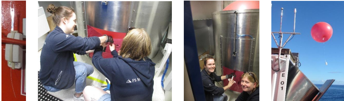
Abbildung 2: Eine Radiosonde (links) wird an einen mit Helium gefüllten Ballon befestigt (mitte: mit Jennica Frederick links und Josy Bergmann rechts) und dann gestartet (rechts) (Fotos: Stefan Kinne).
