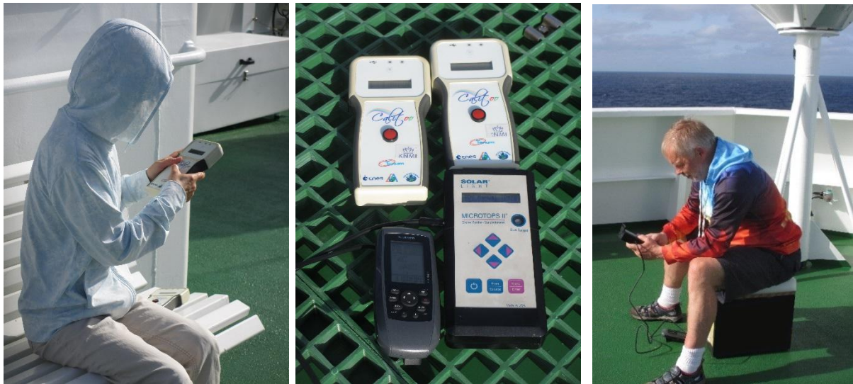
Abbildung 1: Handgehaltene Sonnenphotometer-Messungen auf dem Peildeck mit den CALITOOs durch Ping Wang (links, Foto: Stefan Kinne) und mit dem MICROTOS durch Stefan Kinne (rechts, Foto: Ping Wang). Das mittlere Foto zeigt eine Detailaufnahme der Instrumente (Foto: Stefan Kinne).
