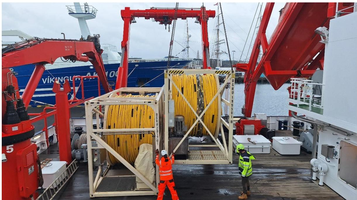
*Verladen der beiden Winden mit insgesamt mehr als 6 km seismischen Messkabel.*
