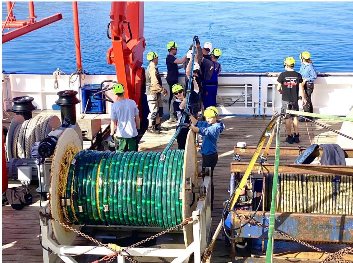
*Abbildung 2: Aussetzen der seismischen Hydrophonschleppkette. Foto: H. Jähmlich.*
