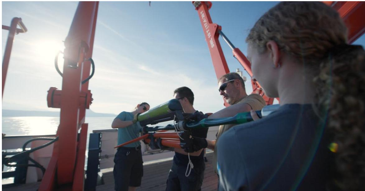
Abbildung 2: Ausbringen des 800 m langen Empfangssystems für die reflexionsseismischen Messungen.
