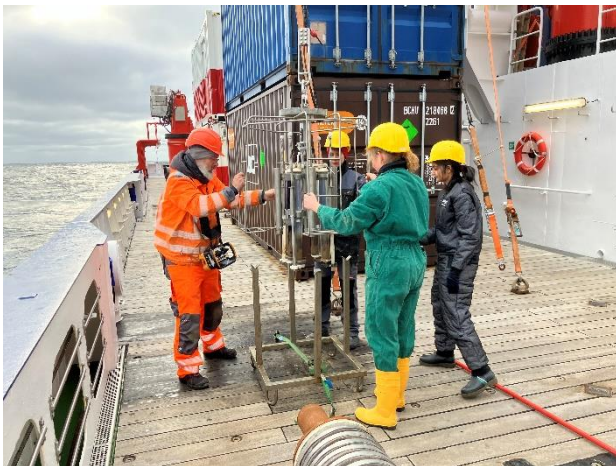
Abbildung 1: Der Mini-Corer ist unser leichtestes Gerät mit dem wir, bei erfolgreichem Einsatz vier sehr gute Kernsegmente der exakten Oberfläche des Meeresbodens sowie das darüberstehende Bodenwasser bekommen (© Gerhard Bohrmann).
