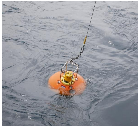
Ausbringung eines großen Auftriebskörpers als Teil von K1 Verankerung (Foto: Stefanie Brechtelsbauer)
