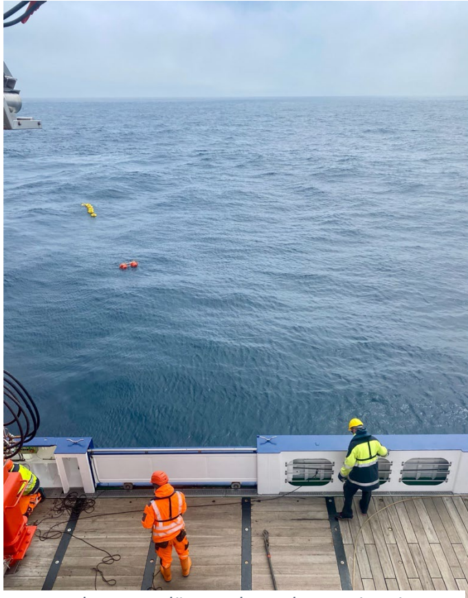
Nach Fernauslösung des Ankers steigt eine Verankerung an die Meeresoberfläche wo sie dann mit dem Schiff geborgen wird. (Foto: Fehmi Dilmahamod)
