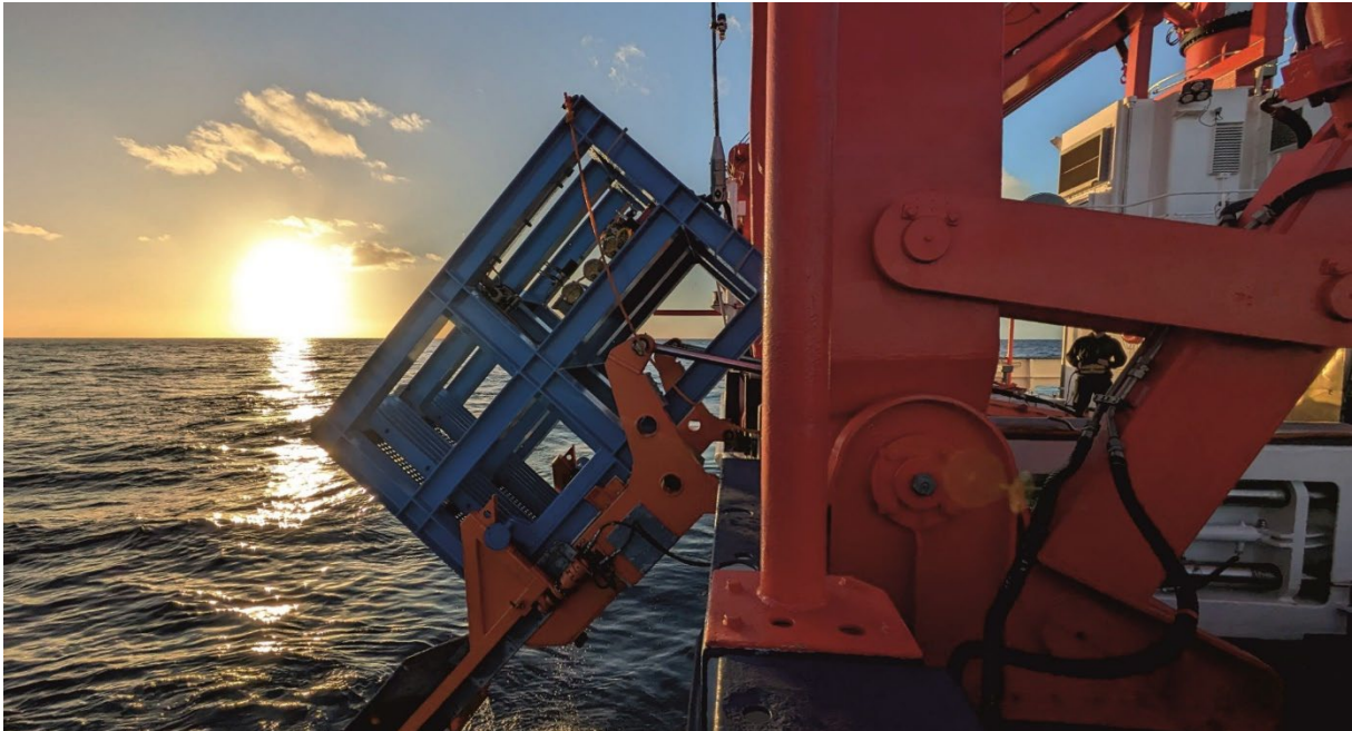
Abb. 1: Im letzten Tageslicht kommt der Testrahmen (hier noch ohne zusätzliche Gewichtsplatten) am Hybridkabel wieder an Bord des Forschungsschiffes MARIA S. MERIAN (Foto: M. Bergenthal)
