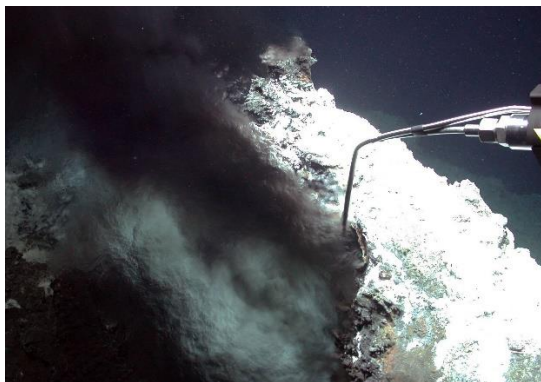
Abb. 5: Die Temperaturmessung am Black Smoker ergab, dass die Fluide über 300 °C heiß sind. (MSM109; ROV-Tauchgang 463).
