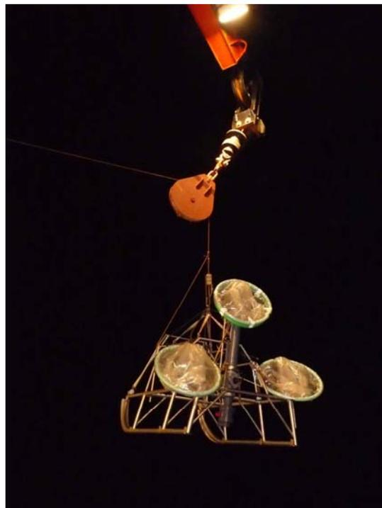
Schlitten mit Partikelkamera und Sedimentationsfallen, der für mehrere Stunden auf dem Boden angesetzt wird, um Daten zum Partikelfluss zu generieren (Foto: M.Böttcher)
