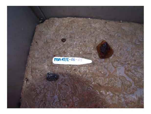
Oberfläche eines Großkastengreifers mit Dropstones, die mit Eisbergen in dieses Gebiet eingetragen wurden.
