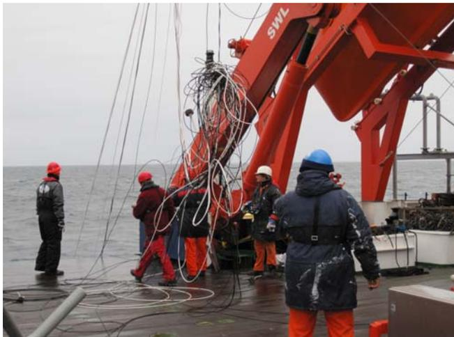
*Drahtwuling: Bergung der treibenden Verankerung K9. Während der fünfwöchigen Drift hatten sich die Drähte so verknotet, dass die Messgeräte wie die sprichwörtlichen Nadeln im Heuhaufen gesucht werden mussten.*
