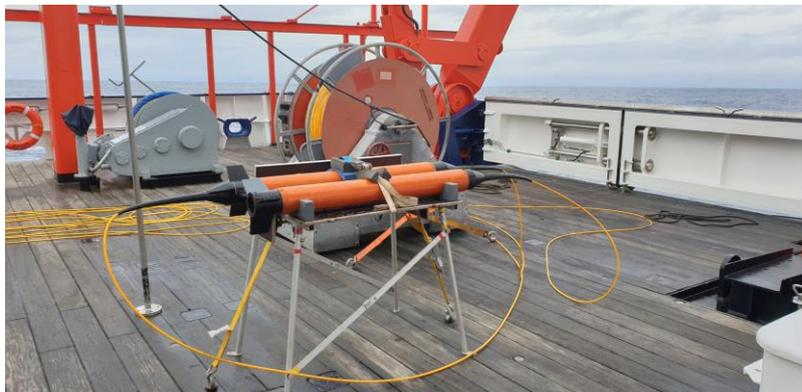
*Magnetisches Gradiometer der Universität Hamburg; beide Sensoren haben beim Einsatz einen Abstand von 100 m und werden 300 m hinter dem Heck des Schiffs geschleppt.*
