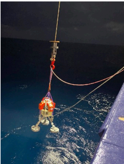
Lander (PIES) beim Aussetzen nahe der Verankerung GB4. Das Gerät misst Bodendruck und Laufzeiten akustischer Signale vom Meeresboden zur Oberfläche (Foto: Eleanor Frajka-Williams).
