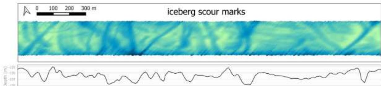
*Eisberg-Schleifmarken in den am Meeresboden anstehenden Moränen des Laurentidischen Eisschildes in Wassertiefen bei 100 m im zentralen Foxe Basin. Die obere Abbildung zeigt einen Ausschnitt der Kartierung mit dem Fächerecholot EM712, die untere Abbildung das entsprechende Tiefenprofil mit bis zu 3 m tiefen Furchen (Abb. S. Papenmeier).*
