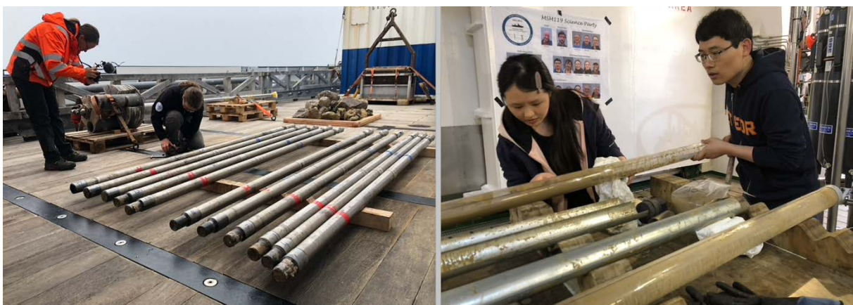
Abbildung 1 Links: Über 25m tief in den Meeresboden ging die zweite MeBo-Bohrung, die beim Abbergen des Bohrstrangs auch geloggt wurde. Rechts: Das Kernmaterial durchhörte Sedimente bis zur Ozeankruste.
