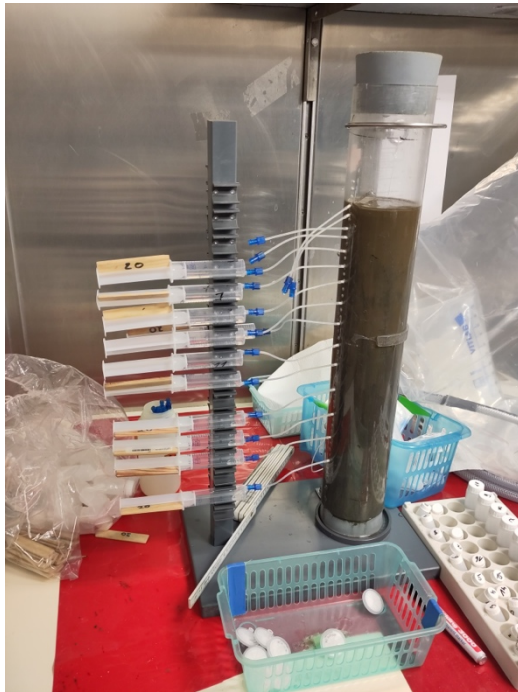
Abb. links: Porenwasserextraktion aus einem Multicorer-Kern mit Rhizonen in 1 cm Abständen im Kühlraum (Foto F. Scholz)
