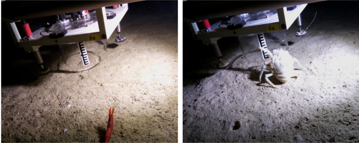
Abb. 2: Zylindrische Messkammern an der Vorderseite des Rovers werden bei der Messung in das Sediment eingefahren und dienen der Erfassung des Sauerstoffverbrauchs der in der Messkammer eingeschlossenen Lebensgemeinschaft. Krebse entziehen sich dieser Messung und verfolgen kritisch das Geschehen.
