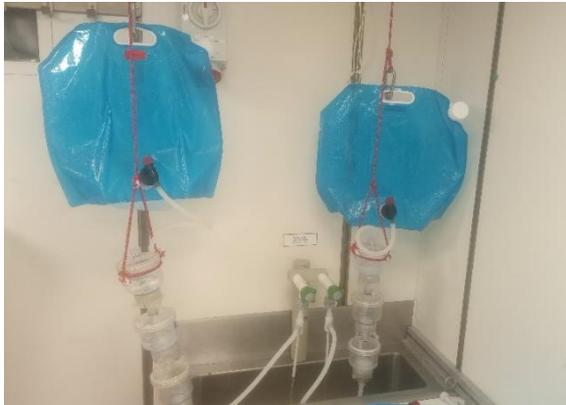
Abbildung 3: Filtrationsanlage zur Auftrennung der verschiedenen Größenklassen von Einzellern zur nachfolgenden DNA-Extraktion. Dabei werden jeweils 20l Oberflächenwasser, Chlorophyll Maximum und 500m in Triplikaten gefiltert.
