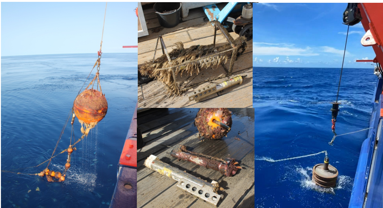
Abb. 1: Aufnahme der oberflächen-nahen großen Auftriebskugel bei CVOO (links, Foto: Linus Gummert). Verschiedene Instrumente mehr oder weniger stark bewachsen (mittlere Bilder, Fotos: Linus Gummert). Wurf des allerletzten Ankersteins auf MSM117 (rechts, Foto: Sunke Schmidt).
